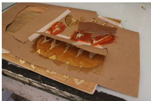
Fig. 24. Stencil con huecos y ventanas
