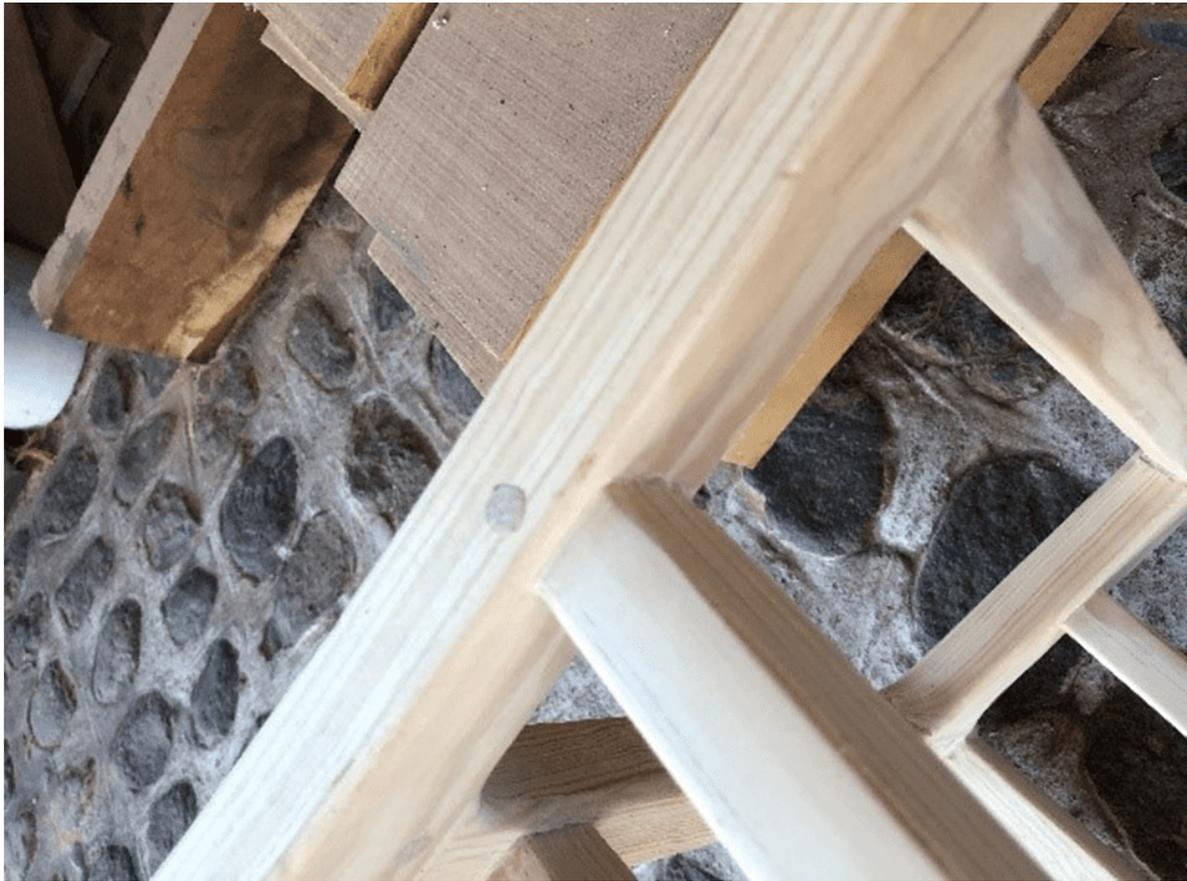
*Fig.08 Detalle de ensamble en silla con taquete de madera. Fotografía de autoría de Elsa Guerra*
