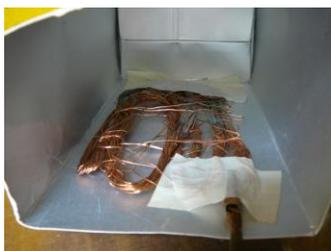
Fig. 1: Sistema para electrólisis empleando una caja Tetrabrik® y un manojo de cables de cobre, como metal más noble para el grabado por el método de Sacrificio metálico.
