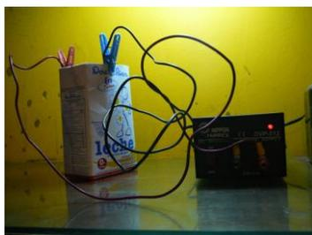
Fig. 2: Sistema de electrólisis, el cable positivo (rojo) está conectado a la placa a grabar y el negativo (negro) a la maraña de alambres de cobre, ilustrada en la figura 1. El electrolito es agua con sal. La fuente de poder suministra 5A y 6 voltios (fue modificada para suministrar este voltaje).
