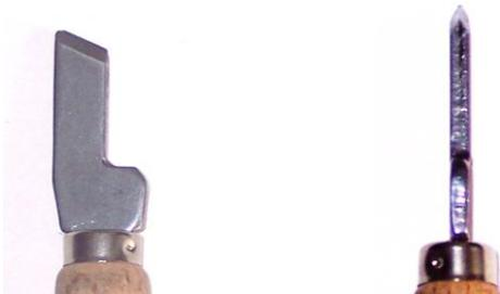
(Fig. 8) Cuchilla para cuero (sección de perfil y frontal)
