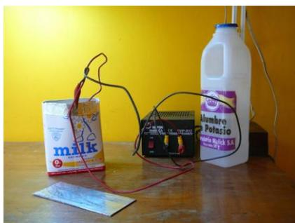
Figura 5. Sistema de grabado electrolítico en placa de aluminio, empleando alumbre (KAl SO<sub>4</sub>) como electrolito, en un recipiente tetrabrik y usando papel de aluminio como receptor. Sobre la mesa hay otra placa de aluminio quemada previamente con este método.
